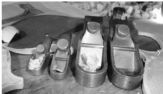
Les rabots d'un luthier. Le plus petit s'appelle «noisette».
